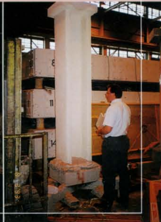
▲ H-column 經防火測試後，依然完好堅固。
