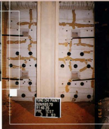
▲ UL 防火測試-H-column (燃燒前)
